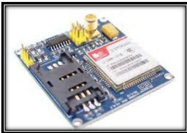
Figure 5. GSM module
